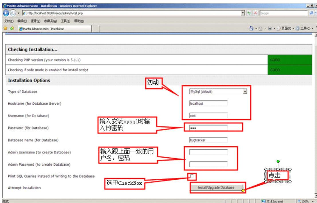
4、Database 输入为 Mantis，点击后出现下图。注意：installing Database 没有插入成功，把 SQL 拷贝出来。
