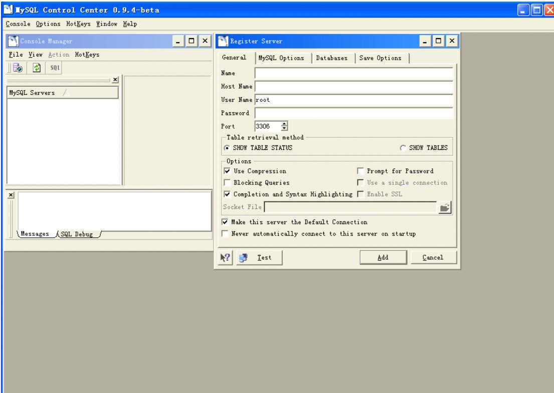
3、在 name 中填 root，在 hostname 中填 localhost，在 Password 中输入刚刚设置的 root 密码。填完后，点 ADD 按钮。
